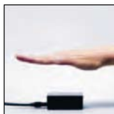
Sensor sendet Infrarotstrahlung an die Hand, venöses Blut absorbiert Strahlung
